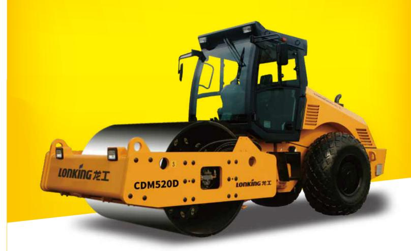
RATED POWER: 160kW/2200rpm
